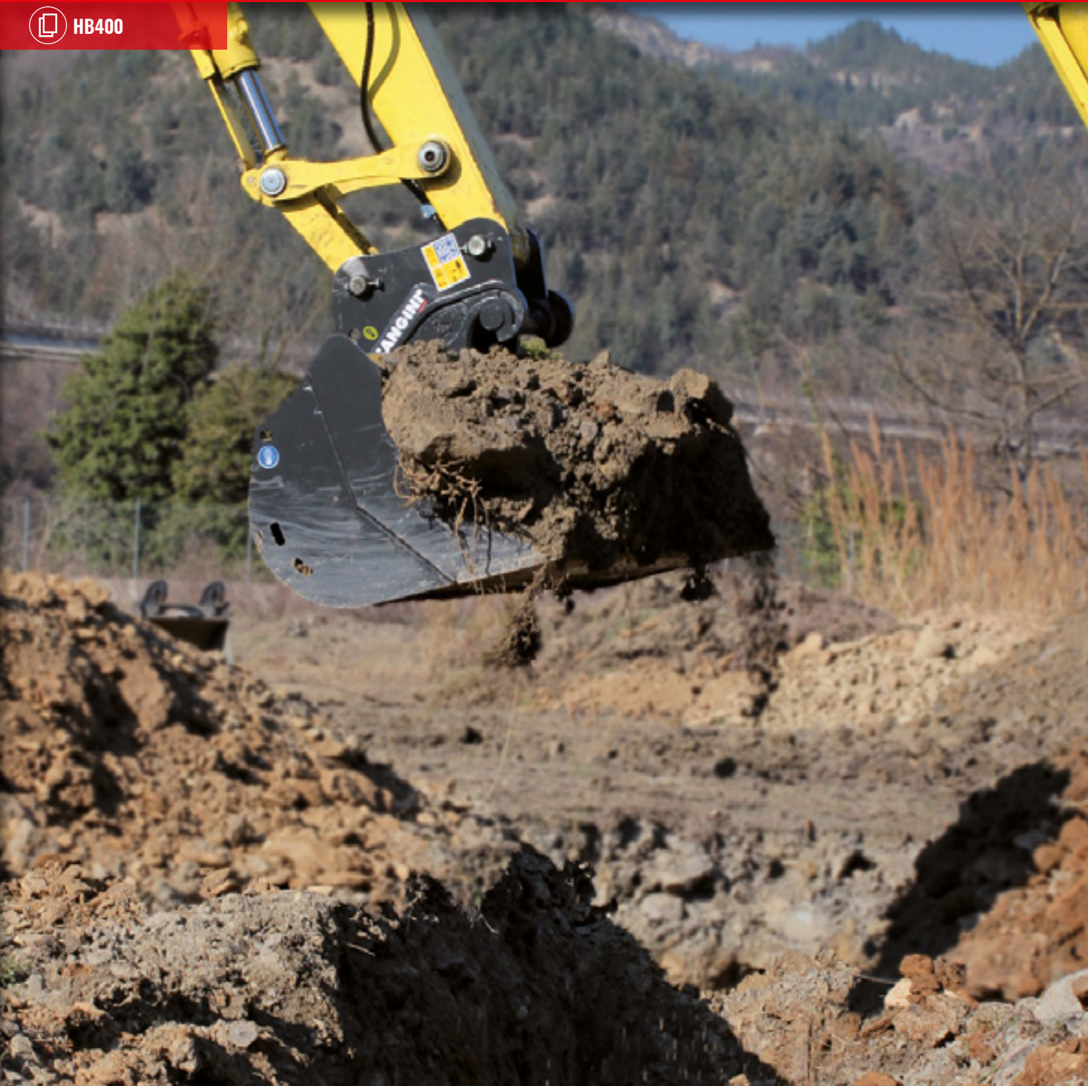
BÖSCHUNGSLÖFFEL MIT VORGEZOGENEM PROFIL FÜR LEHMIGE UND FEUCHTE BÖDEN. ZUM EINEBNEN UND RÄUMEN VON STRASSEN, GRÄBEN UND BÖSCHUNGEN. SCHNEIDE AUS 400HB-STAHL.
