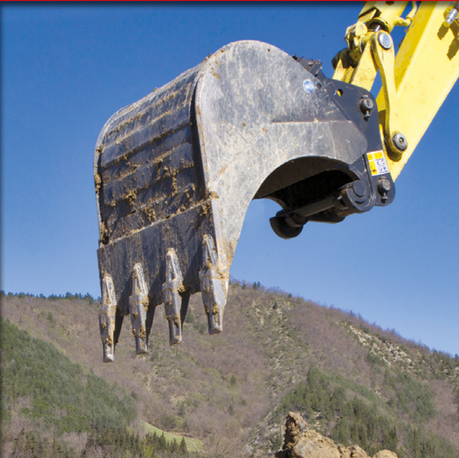
OPTIMIERTE LÖFFELKÖRPERFORM FÜR REDUZIERTEN KRAFTEINSATZ DER MASCHINE BEIM EINDRINGEN IN MITTELFESTEN BODEN, HOHEN FÜLLGRAD UND STABILES UMSCHLAGEN.
