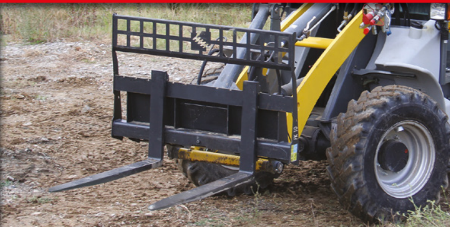
PALETTENGABEL ZUM ANBAU AN SKIDLOADER, RAD-, TELESKOP- UND BAGGERLADER. EIN KLAPPBARES SCHUTZGITTER SICHERT DIE LADUNG WÄHREND DER FAHRT.
